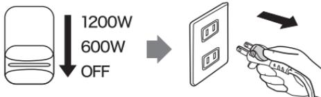
電源プラグを抜くときは、電源プラグを持って抜いてください。レバーを押すとプラグが楽に抜けます。
