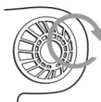
高性能フィルターの凹部を本体の凸部に合わせてはめ、止まるまで右に回して取り付ける。
